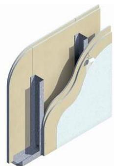
Le pareti divisorie in fibro-gesso sono già idonee per effettuare ancoraggi in parete in funzione dell'allestimento di arredo (cucina, bagni.) e per l'aggancio di pensili. Nei bagni verranno utilizzate delle lastre idrorepellenti tipo Gyproc Hydro.
